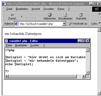
Bild 3.4: Variablen werden überschrieben.
