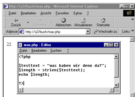
Bild 3.21: Mit strlen() wird die Länge eines Strings ausgegeben
