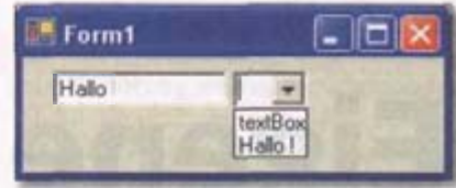
DAS EIGENE CONTROL IN AKTION: Eingegabene Texte werden in der Combo-Box zur Auswahl angeboten.
