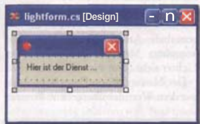
EINE 'AMPEL': Dieses Objekt wird für Skript verfügbar gemacht und kann dann auch von Skript aus gesteuert werden.
