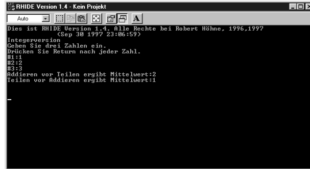
Abbildung 5.1: Der Division-vor-Addition-Algorithmus hat große Probleme mit Rundungsfehlern.
