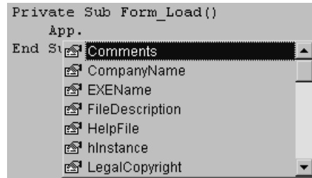
Bild 1.2: Nach der Eingabe des Objektnamens und des Punktes erscheint eine Auswahlliste mit allen Eigenschaften und Methoden des Objekts
