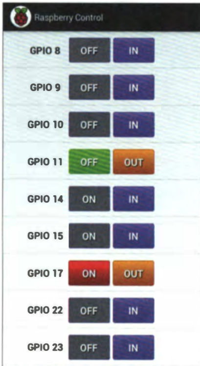
6 Raspberry Control erlaubt das Ansteuern der einzelnen GPIO-Pins des RasPi.
