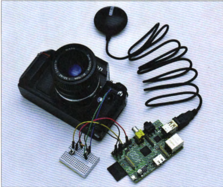
3 Wochenend-Projekt mit allen Schikanen: Die analoge Spiegelreflexkamera und der GPS-Empfänger mit dem Raspberry Pi fertig verdrahtet.
