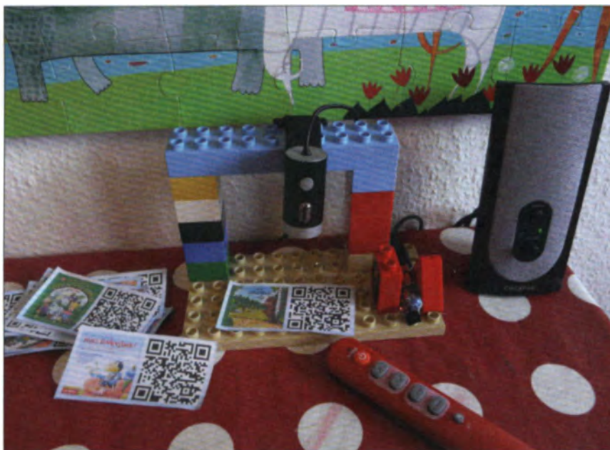
4 Eine Lego-Halterung sorgt dafür, dass das Einlesen der QR-Codes reibungslos klappt.
