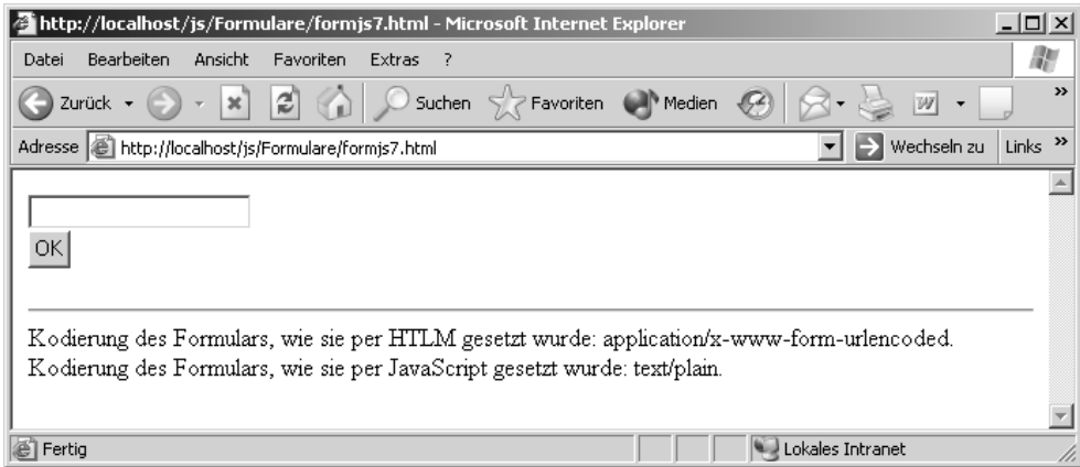
Abbildung 88: Die erste Ausgabe ist die Defaultkodierung, und anschließend folgt die neue Kodierung.
