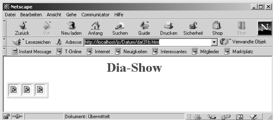
Abbildung 329: Der Netscape Navigator 4.7 kommt nicht zurecht, wenn Sie in den <img> -Tags nicht per HTML bereits ein anfängliches Bild referenzieren.
