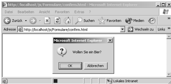
Abbildung 71: Beim Laden der Webseite wird der confirm -Dialog angezeigt.
