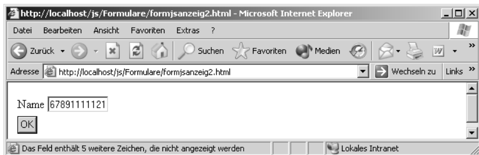
Abbildung 141: In der Statuszeile wird dem Anwender angezeigt, dass es Zeichen gibt, die nicht angezeigt werden.
