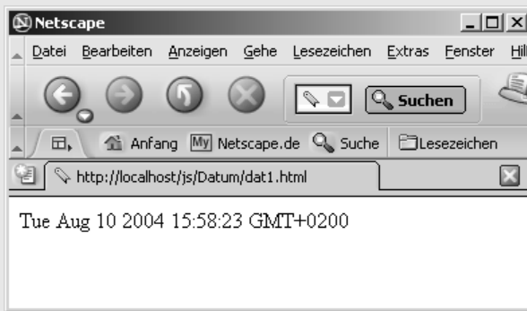
Abbildung 273: Die unformatierte Ausgabe des Systemdatums – hier im Netscape Navigator 7.1
