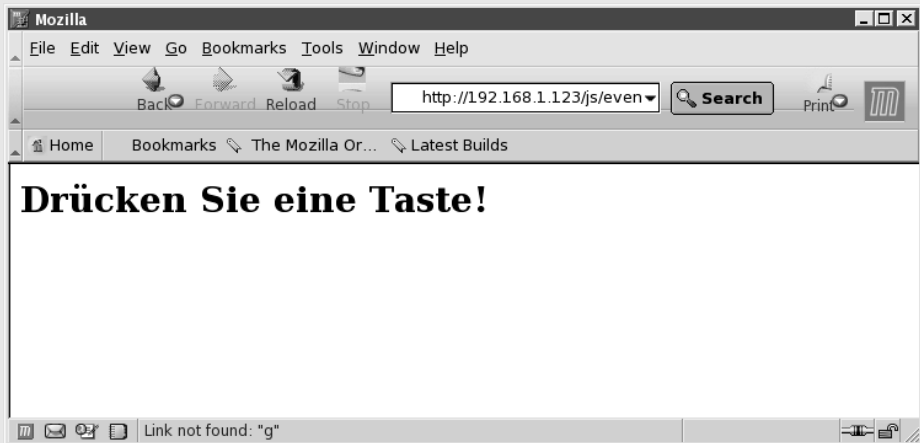
Abbildung 415: In der Statuszeile des Mozillas deutet die seltsame Meldung das Problem bei der Ausgabe in der Statuszeile an – hier wurde die g-Taste gedrückt.
