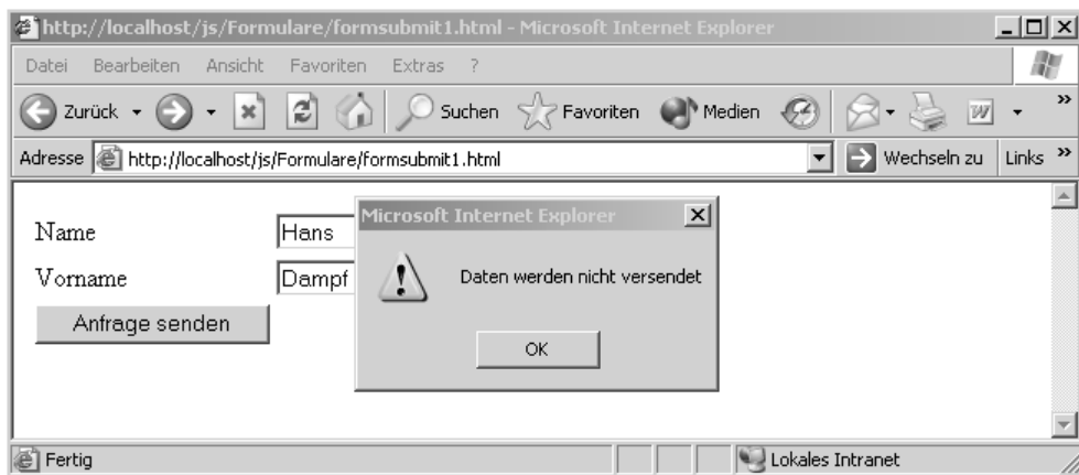
Abbildung 123: Die mit onSubmit aufgerufene Funktion liefert false , und die Formulardaten werden nicht versendet.
