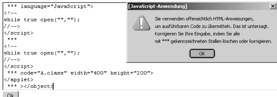
Abbildung 269: Beim Verlassen des Formularfelds werden die kritischen Anweisungen ersetzt und eine Fehlermeldung angezeigt.
