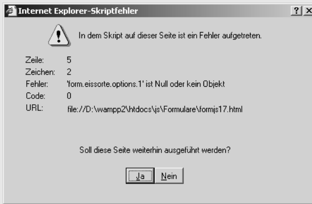
Abbildung 107: Der Versuch einer Textzuweisung zu einem nicht vorhandenen Eintrag in einer Auswahlliste
