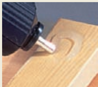
Der Kleber ist in geschmolzenem Zustand hell-elfenbein und nach dem Erstarren weiß-kristallin.
