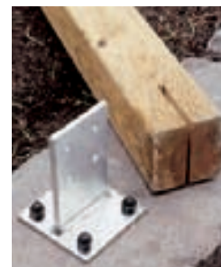
Um Zaunpfähle auf Mauern zu verankern, verwendet man Pfostenanker zum Aufdübeln. Es gibt verschiedene Konstruktionen mit unterschiedlichen Befestigungsarten, zum Beispiel U-förmige, die den Pfosten umgreifen, oder solche mit Mittelsteg, die einen geschlitzten Pfosten aufnehmen.
