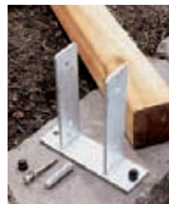
Um Zaunpfähle auf Mauern zu verankern, verwendet man Pfostenanker zum Aufdübeln. Es gibt verschiedene Konstruktionen mit unterschiedlichen Befestigungsarten, zum Beispiel U-förmige, die den Pfosten umgreifen, oder solche mit Mittelsteg, die einen geschlitzten Pfosten aufnehmen.
