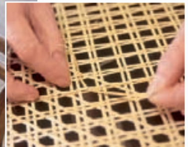
STUHL SITZE FLECHTEN erfordert viel Konzentration. Die Gesellin Petra Klitzke hat sich darauf spezialisiert und flicht die Streifen aus dem Stamm der Rotangpalme schnell und sicher von Rahmenloch zu Rahmenloch – diagonal, senkrecht und waagrecht, bis das Sechseckgeflecht fertig ist.
