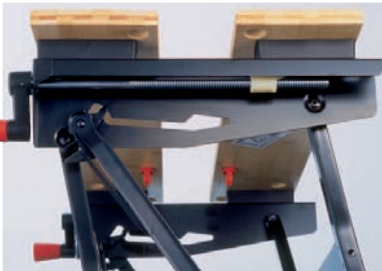
Zwei Spindelantriebe bewegen die hintere Tischhälfte zum Einspannen der Werkstücke. Bedient werden sie über zwei Kurbeln an der Frontseite der Werkbank. Das funktioniert gut – trotz eines erheblichen Spiels von Spindel und Kurbel.
