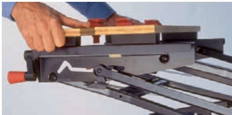
Das Aufstellen der Workmate geschieht mit einem Zug am Werkstisch nach oben. Ein Fuß auf dem Trittbrett hilft, das schwergängige Gestell auszuklappen. Beim Zusammenklappen unbedingt alle Finger von den Gestellscheren fernhalten.
