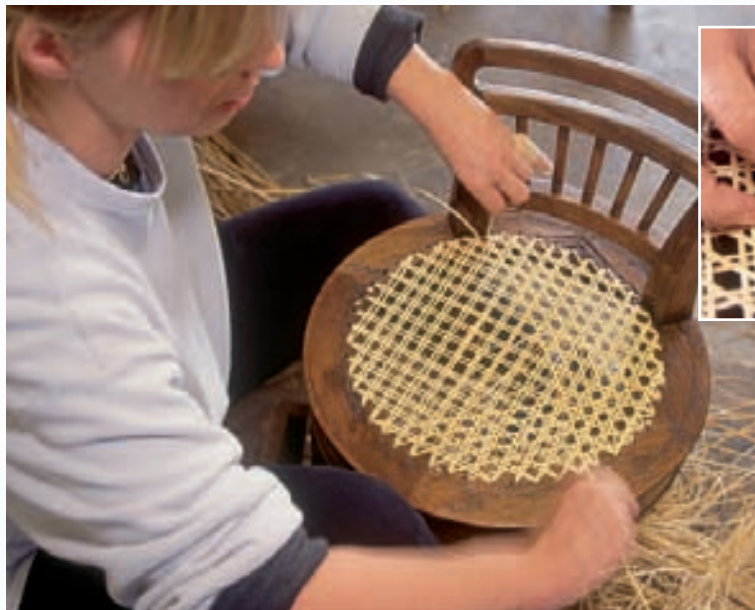
STUHL SITZE FLECHTEN erfordert viel Konzentration. Die Gesellin Petra Klitzke hat sich darauf spezialisiert und flicht die Streifen aus dem Stamm der Rotangpalme schnell und sicher von Rahmenloch zu Rahmenloch – diagonal, senkrecht und waagrecht, bis das Sechseckgeflecht fertig ist.
