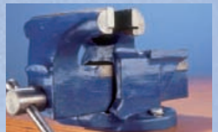
Billigschraubstock aus Stahlguss, wie er vor allem aus Fernost importiert wird. Dieser sieht neu schon aus wie ein Trümmerhaufen.
