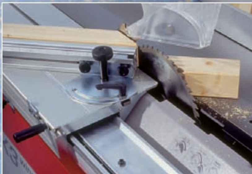
Der Winkelanschlag am Schiebetisch hat eine Skala von 90° bis 45°, der Einstellmechanismus ist jedoch sehr einfach. Für höchste Präzision der Sägeschnitte musste er meist etwas nachkorrigiert werden.
