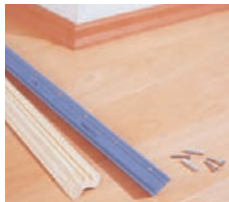
25 Der Einsatz von zweiteiligen Fußleisten bedingt gerade Wände. Grundschiene in der Wand verdübeln und die Deckschiene aufschieben.
