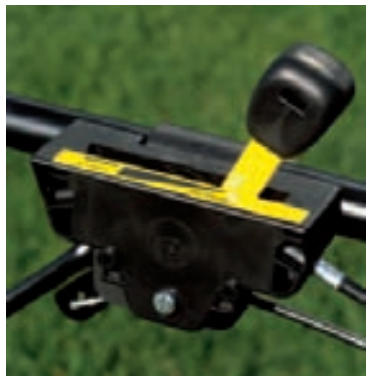
Nur zwei Einstellungen für Start (Choke) und normalen Betrieb hat die Motorsteuerung des Esprit 40 H von Wolf-Garten.
