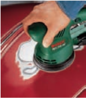
Bei Innen- und Außenrundungen empfiehlt es sich, einen weichen Schleifteller zu nehmen. Viele Hersteller bieten unterschiedlich harte Schleifteller im Zubehör an.
