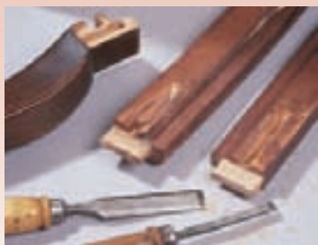
Leimreste gründlich von den Verbindungszapfen und aus den Zapfenlöchern entfernen.
