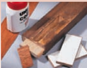
Zu dünn geratene Zapfen können mit Furnierstücken nachgearbeitet werden. Faserrichtung einhalten!
