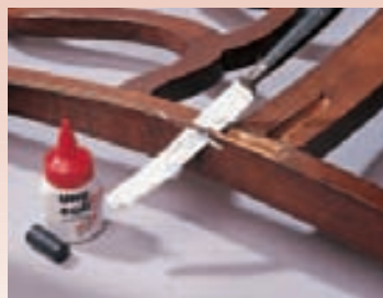
Bei abstehenden Holzsplittern mit einer Klinge Leim auftragen. Dann die Stelle mit Klebeband fixieren.
