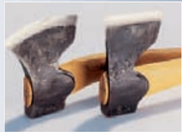
Schneidenform: Bogenförmig zum Spalten und gerade zum Schnitzen und andere formenden Arbeiten mit Holz,
