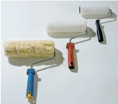
6 Untergrund und Farbe bestimmen die Florlänge. Langflorige für grobe Wandstrukturen, mittlere für glatte Wände, kurze für feste Farben.
