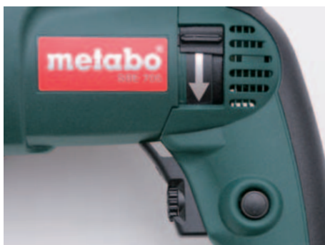
Der große Schalter für die Umschaltung der Bürstenplatte (Laufrichtung) bei der Metabo SBE 705 erfordert lange Finger.
