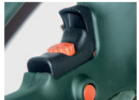
Die Schalterwippe bei der Black & Decker KR 999 steht beim Rechtslauf in mittlerer Position und wird zum Linkslauf zur Seite gedrückt.
