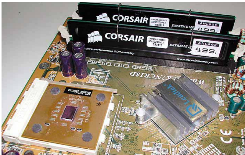
Bezahlbare AMD-Traumkombi: Athlon XP/2800+ mit FSB333, zwei gleichen PC2700-Module (DDR333) und der Nforce-2-Chipsatz schlagen den P4/2,8 GHz in Aquamark, Quake 3 und Serious Sam: 2nd Encounter.
