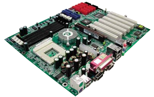
Das Epox 8K5A3+ ist umfangreich ausgestattet. Erstmals lässt sich der vierte DDR-Speichersteckplatz vernünftig nutzen.
