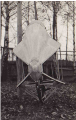
Rohbau des Rumpfbugs
