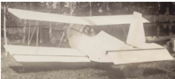
Die Ansicht von hinten zeigt die Querruder allein am Unterdeck des Doppeldeckers (1929).
