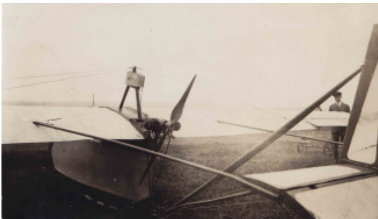
„Zaunkönig“ mit dem Prüssing-Motor (DKW) im September 1931. Deutlich zu erkennen ist die zusätzliche Abstrebung von der Seitenflosse zum unteren Ende des Rumpfbotes – ein Detail, das in der Dreiseitenansicht in der Zeitschrift „Flugsport“ noch nicht enthalten ist.
