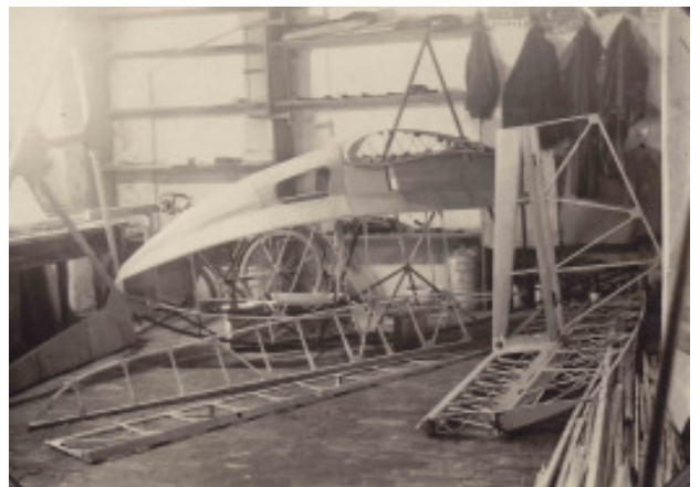
Der Rumpfbug des „Zaunkönig“ und vorn das Höhen- sowie Seitenleitwerk. Das Bild entstand vermutlich 1932 bis 1933 während der Modifizierung des Leichtflugzeuges in der provisorischen Werkstatt des Chemischen Instituts in Chemnitz.
