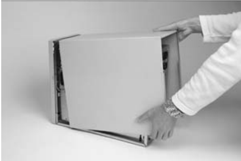
Bild 4.9: Bevor Sie den Deckel anheben können, muss dieser erst ein Stück nach hinten gezogen werden.
