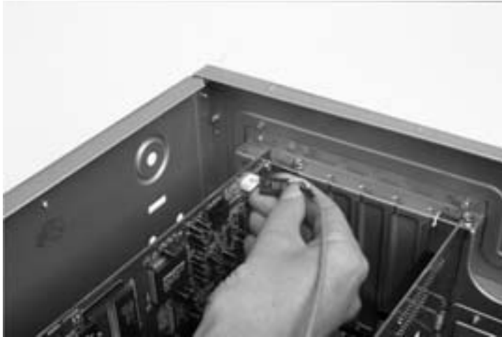
Bild 15.6: Zum guten Ton gehört nicht zuletzt auch der Anschluss des Audiokabels vom CD-ROM-Laufwerk, ...
