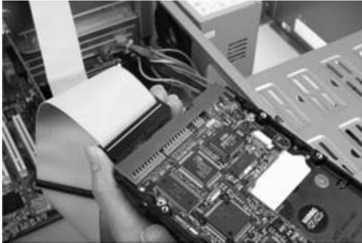
Bild 9.6: Auch bei der Festplatte sitzt der Pin 1 meistens neben dem Stromanschluss.
