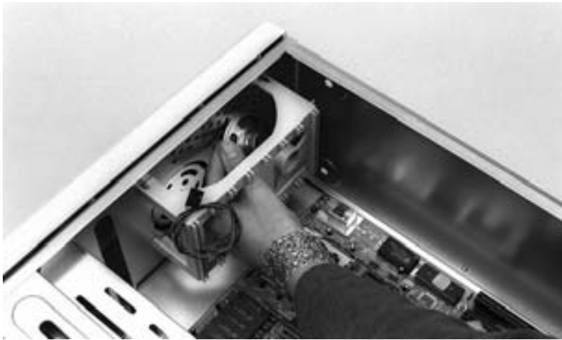
Bild 4.15: So kann die Montage des Lautsprechers schon mal etwas fummelig werden.
