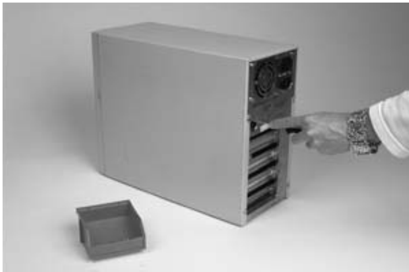
Bild 4.4: Verwechseln Sie sie nicht mit den Netzteilschrauben: Die Deckelschrauben sitzen immer ganz außen, meistens hinten, ...
