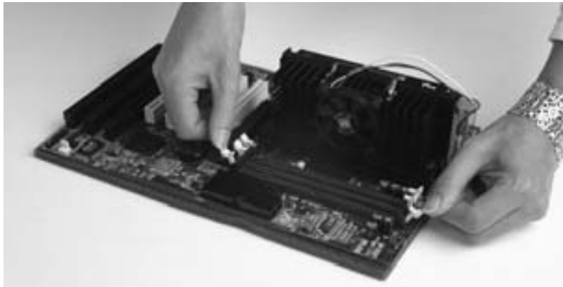
Bild 7.6: Erst mal öffnen: Vor dem Einsetzen des Speichermoduls müssen die Halteklammern aus dem Weg.
