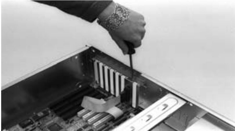
Bild 5.2: Das schafft Platz: Die parallele Schnittstelle wird vom Steckplatz entfernt ...
