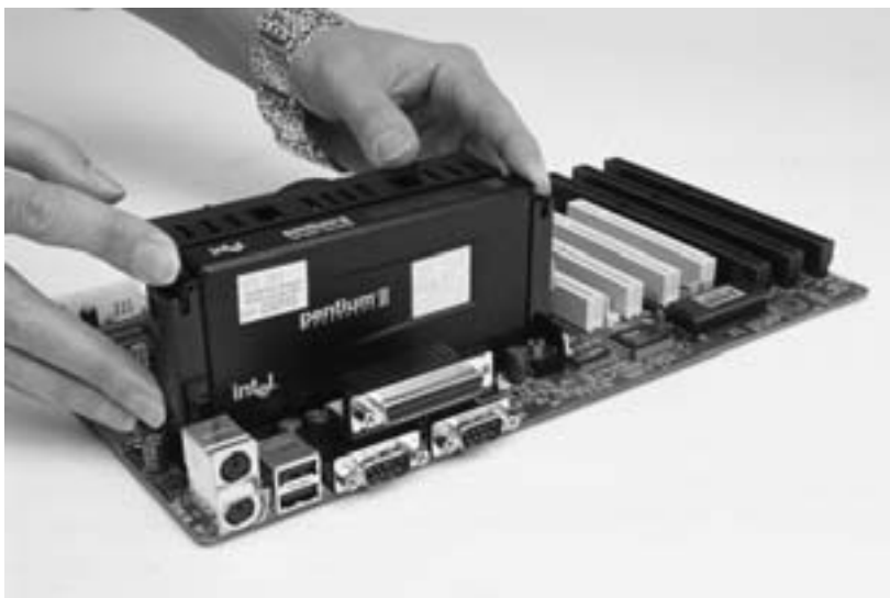
Bild 8.13: Ausgeklammert: Ein Pentium II/III oder Athlon verlässt erst dann seinen Slot, wenn die Riegel weggedrückt sind ...
