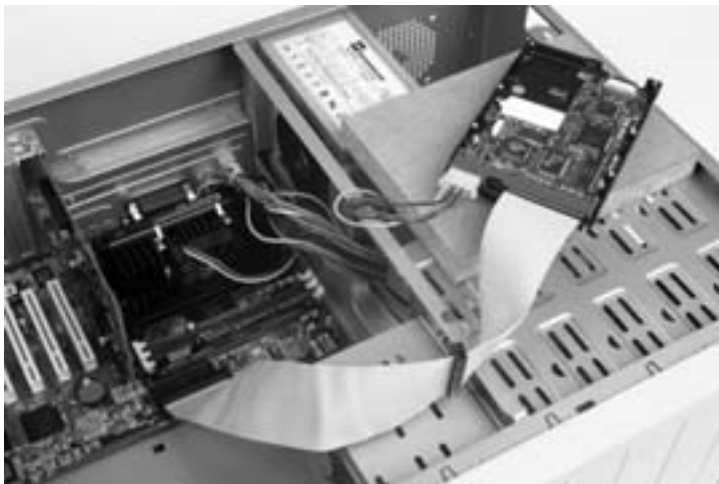
Bild 9.7: Vollständig verkabelt: Die Festplatte wird erst einmal ausprobiert.
