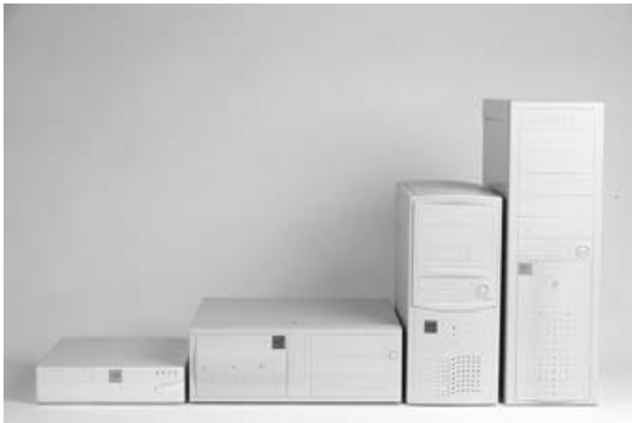
Bild 4.1: Treppengehäuse: Die vier typischen Gehäuseformen v.l.n.r.: Slimline-Gehäuse, Tischgehäuse, Midtower- und Bigtower-Gehäuse
