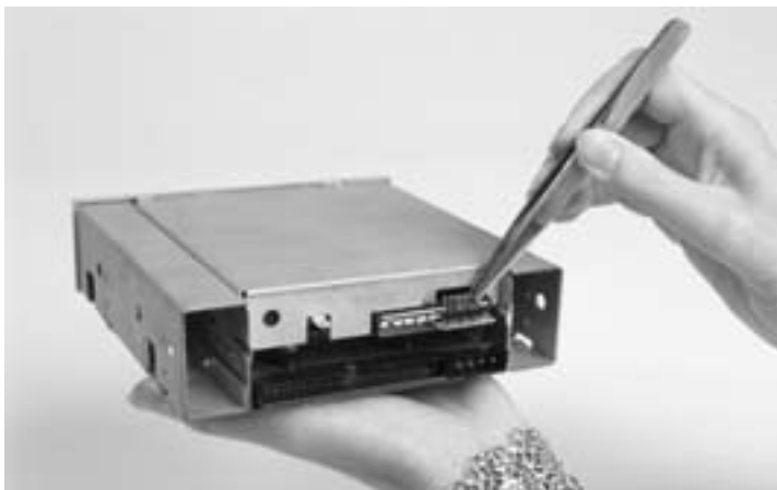
Bild 6.3: Dieses Laufwerk wird über Jumper konfiguriert.
