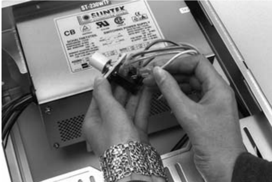
Bild 4.20: Der Aufkleber auf dem Netzteil verrät's: So werden die Kabel am Netzschalter angebracht.
