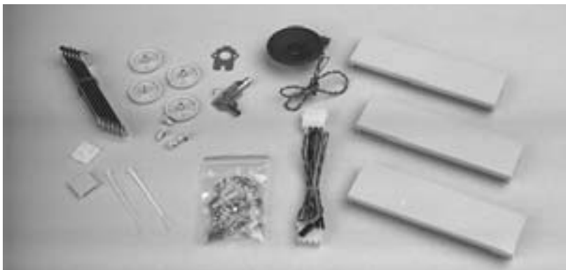
Bild 4.14: Das steckt in der Wundertüte. Laufwerkblenden, Slotblenden, Gehäusefüße und den Lautsprecher müssen Sie selbst montieren. Wenigstens ist der Netzschalter schon angeschlossen.
