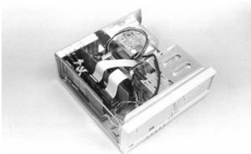
Bild 7.3: Verbaut: Bei diesem PC muss so einiges aus dem Weg, bevor Sie die Speichersockel erreichen können.
