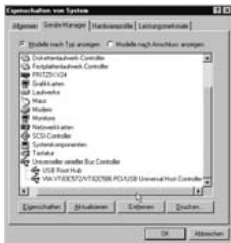
Bild 13.5: Neuankömmlinge: Nach erfolgreicher Treiberinstallation können Sie den USB-Root-Hub und den entsprechenden Chip im Geräte-Manager finden.
