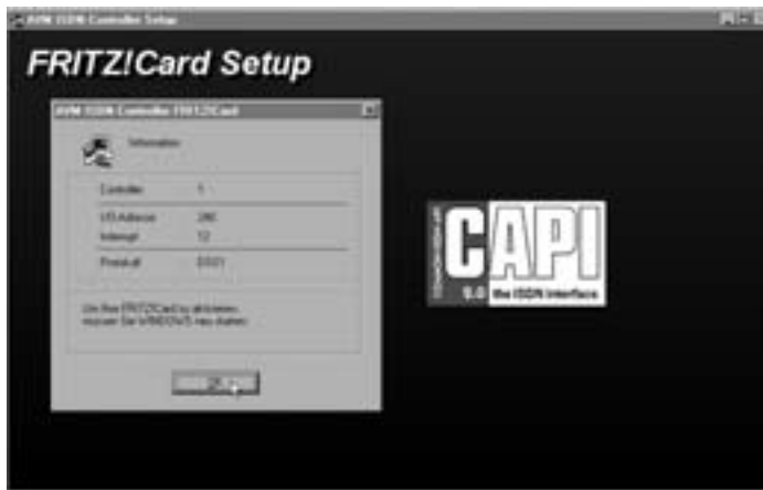
Bild 16.2: Die AVM-Fritz!Card besitzt ein komfortables Installationsprogramm. Die Portadresse wird auf der Karte eingestellt und hier der Software mitgeteilt.
