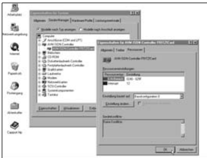
Bild 16.3: Die ISDN-Karte bringt eine eigene Geräteklasse mit, unter der sie im Geräte-Manager zu finden ist. Über Eigenschaften lassen sich die belegten Ressourcen einsehen.
