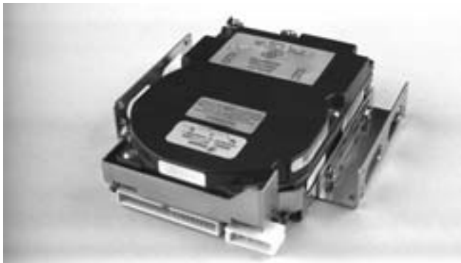
Bild 9.21: Verwinkelt: Manchmal müssen 3.5-Zoll-Festplatten vor dem Einbau etwas verbreitert werden.
