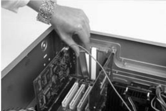
Bild 5.16: Offenheit ist hier nicht gefragt: Die Slotblende wird eingesetzt ...
