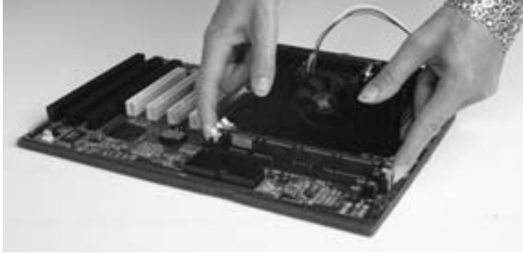
Bild 7.8: Nur wenn das Modul richtig passt, lassen sich die Klammern wieder zuklappen.
