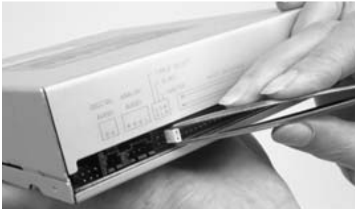
Bild 10.1: Einer muss sich unterordnen: Dieses Laufwerk wird als »Slave« eingestellt.
