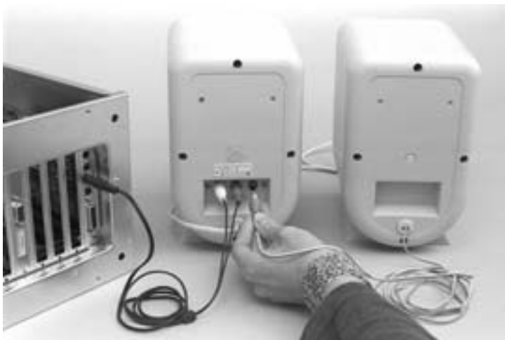
Bild 15.5: Anschließend wird der Aktivlautsprecher mit der Soundkarte und seinem passiven Kollegen verbunden.
