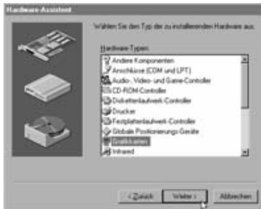
Bild 14.4: Wählen gehen: Wenn Sie auf die automatische Hardwareerkennung verzichten, müssen Sie dem Assistenten erklären, dass Sie einen Grafiktreiber installieren wollen.
