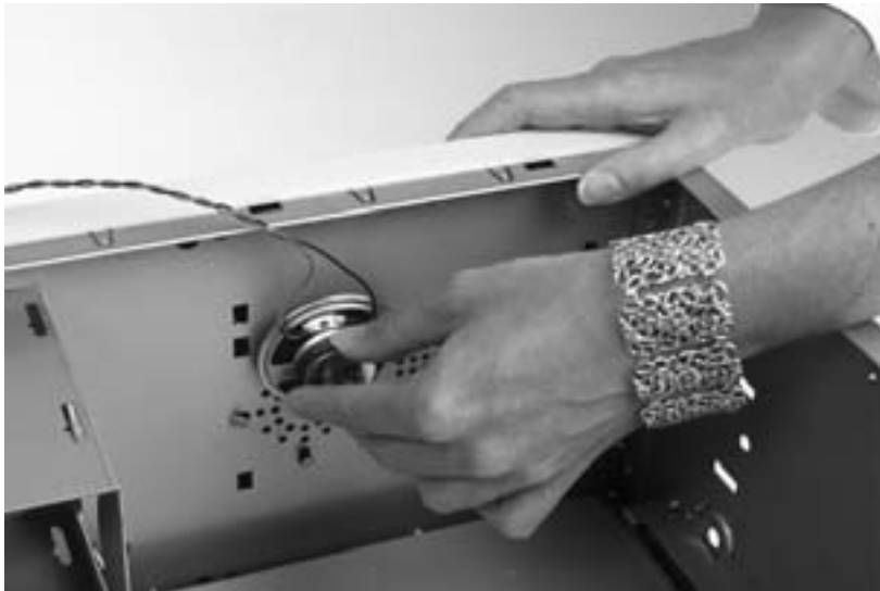
Bild 4.18: So geht's auch: Der Lautsprecher wird festgeklemmt ...
