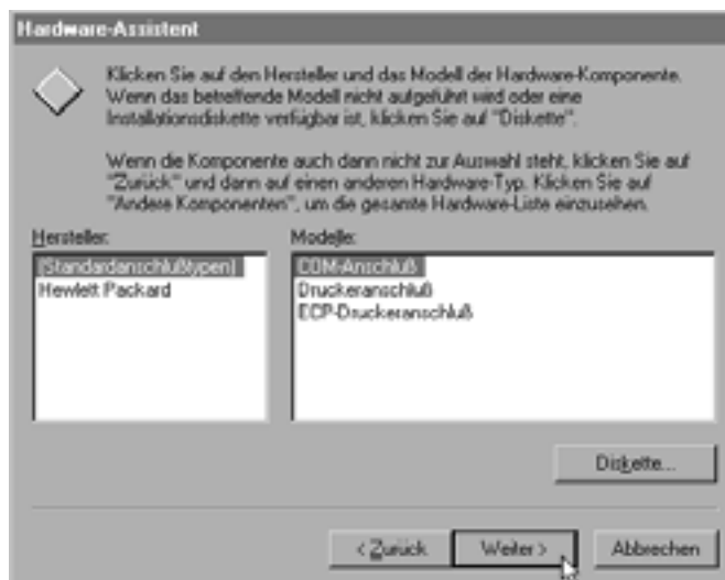
Bild 17.20: Ob Sie nun COM2, COM3 oder COM4 hinzufügen, können Sie nicht bestimmen. Es geht der Reihe nach!
