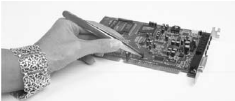
Bild 15.1: Stimmen DMAs, IRQs und Ports? Bei einigen Soundkarten müssen vor dem Einbau eine Reihe von Jumpers überprüft werden.
