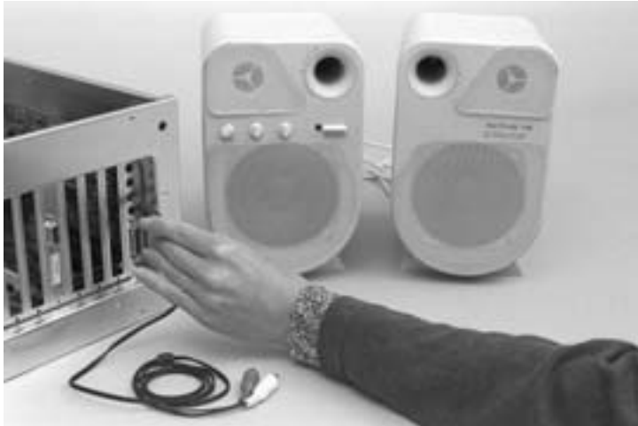
Bild 15.4: Eingeklinkt: Der Klinkenstecker des Lautsprecherkabels wird an die Line-Out-Buchse der Soundkarte angeschlossen.
