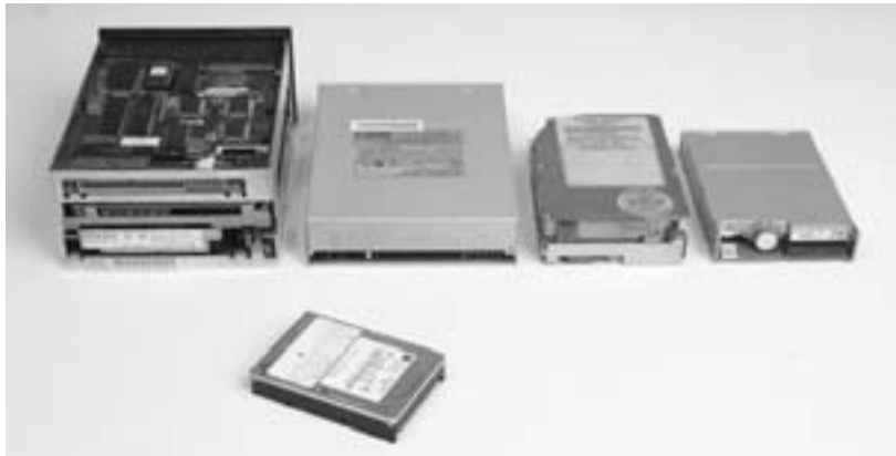
Bild 6.1: Normiert: Laufwerke gibt es nur in festgelegten Abmessungen. V.l.n.r.: 5.25-Zoll-Laufwerk mit voller Bauhöhe, 5.25-Zoll-Laufwerk mit halber Bauhöhe, 3.5-Zoll-Laufwerk, 3.5-Zoll-Laufwerk in 1-Zoll-Bauhöhe. 2.5-Zoll-Laufwerke (vorne) werden nur für Notebooks gebraucht.
