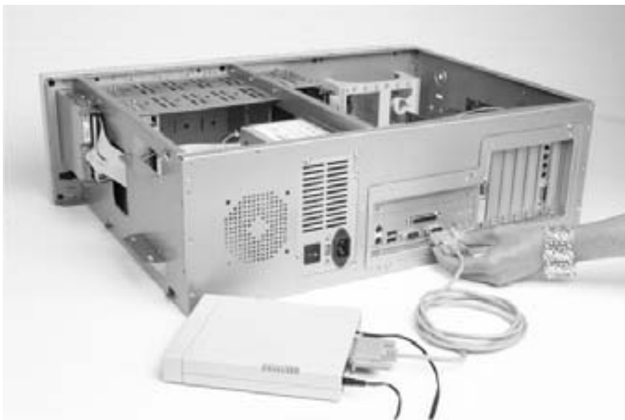
Bild 17.6: Sitzt meistens rechts: Das Modemkabel kommt an die zweite serielle Schnittstelle.
