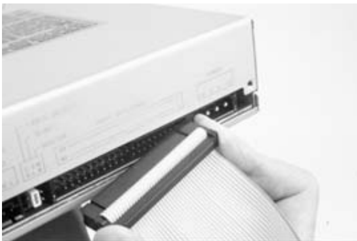
Bild 10.2: Meistens ist er beschriftet: Der Pin 1 sitzt auch bei DVD-Laufwerken fast immer neben dem Stromanschluss.
