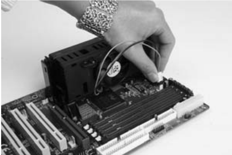
Bild 8.12: Ausgekühlt: Damit das Kabel nicht abreißt, wird es abgezogen.
