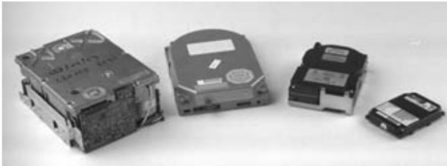
Bild 9.1: Riesen und Zwerge: die Entwicklung der Festplattengröße. Alle diese Formate kommen noch zum Einsatz, allerdings hat ein 5.25-Zoll-Laufwerk mit voller Bauhöhe (links) heute eine Kapazität von etlichen GByte – zehntausendmal mehr als der XT 1982 besaß.
