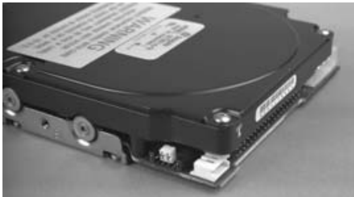
Bild 9.3: Bei dieser SEAGATE-Festplatte sitzen die Jumper an der Seite.
