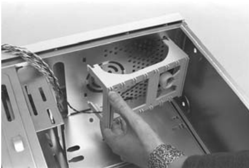
Bild 4.17: ... und anschließend mitsamt dem Lautsprecher wieder einsetzen.
