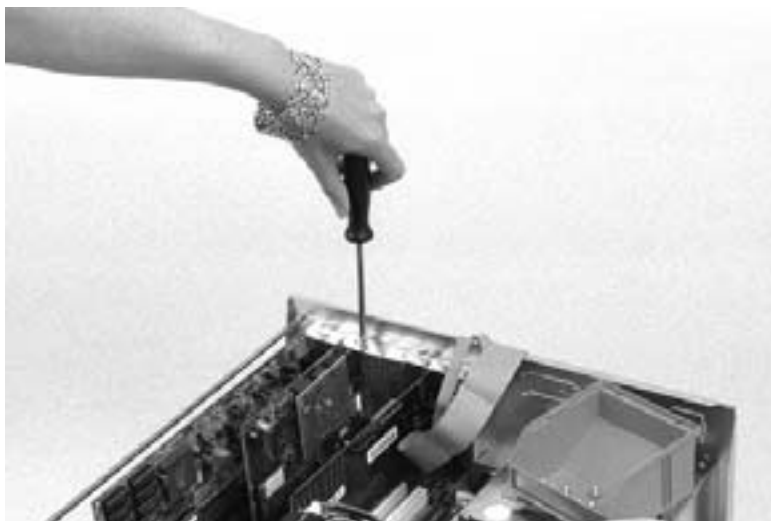
Bild 5.14: Die Erweiterungskarte wird losgeschraubt ...
