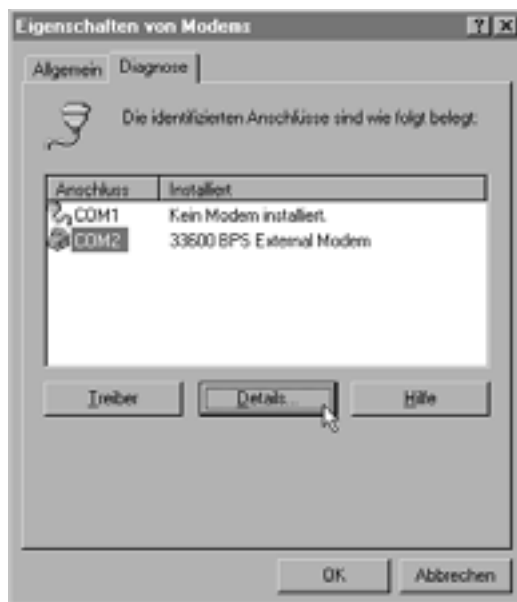
Bild 17.17: Irreführend: Windows zeigt Ihnen hier nur an, wie das Modem eingetragen ist. Ob das auch wirklich stimmt, erfahren Sie erst unter Details.
