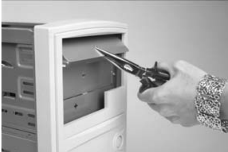
Bild 6.10: Zum Brechen: Die Blechabdeckung des Laufwerkschachts bekommen Sie nur mit sanfter Gewalt heraus.
