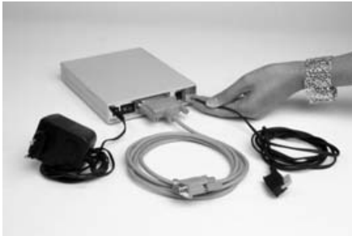
Bild 17.4: Dreierlei: Das Modem wird mit Netzteil, Modemkabel und Telefonkabel verbunden.
