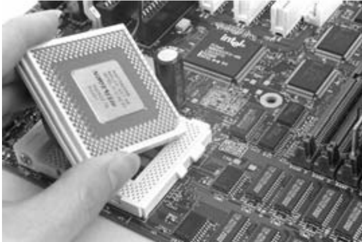
Bild 8.10: Ecke ab: Auf den zweiten Blick ist der Pin 1 sowohl an der CPU als auch am Sockel gut auszumachen.
