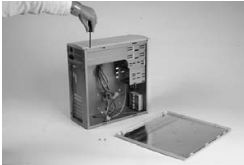
Bild 4.6: Versteckt: Die Schrauben dieses Deckels sitzen unter den Seitenteilen.
