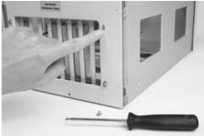
Bild 5.9: Die Schraube muss nicht unbedingt ganz heraus: Solche O-Löcher erlauben die Anpassung des Kartenhalters.
