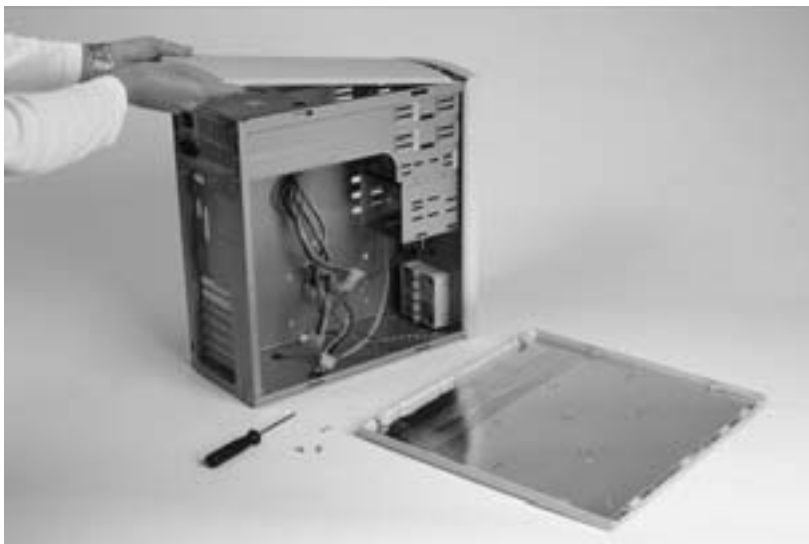
Bild 4.11: Auch der Deckel muss erst ein Stück nach hinten gezogen werden.
