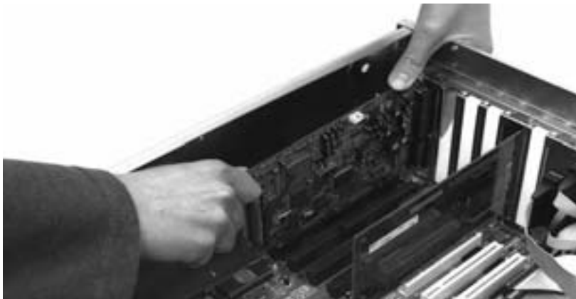
Bild 5.7: Die Erweiterungskarte wird gerade eingesetzt ...
