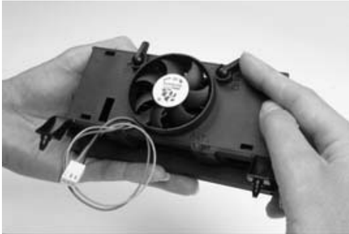
Bild 8.18: Praktisch: Mit solchen Riegeln lässt sich der Kühler schnell festziehen.
