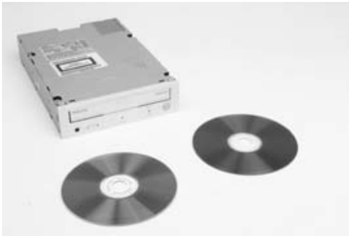
Bild 11.1: Ein CD-Brenner mit Rohlingen. Die dunklere Scheibe kann von einigen CD-Laufwerken nicht richtig gelesen werden.
