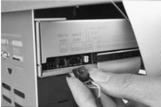
Bild 10.6: Zum guten Ton gehört nicht zuletzt auch der Anschluss des Audiokabels vom DVD-Laufwerk, ...
