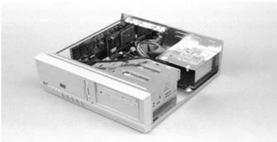
Bild 1.1: Sieht unübersichtlicher aus, als es ist: Im Grunde enthält ein PC neben dem Netzteil (hinten rechts) nur Laufwerke (vorne rechts), Erweiterungskarten (hinten links) und die Hauptplatine (unten und kaum zu erkennen).
