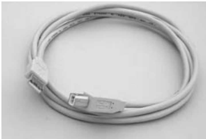
Bild 13.1: Die beiden gebräuchlichen USB-Stecker: links »A« rechts »B«
