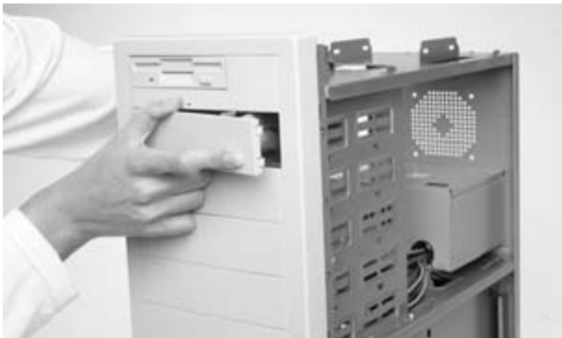
Bild 6.9: Laufwerkblenden lassen sich am besten von hinten herausdrücken.
