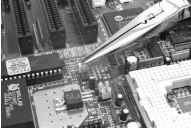
Bild 8.4: Eher die Ausnahme: Bei dieser Hauptplatine benötigen Sie kein Handbuch, um die CPU-Spannung einzustellen.
