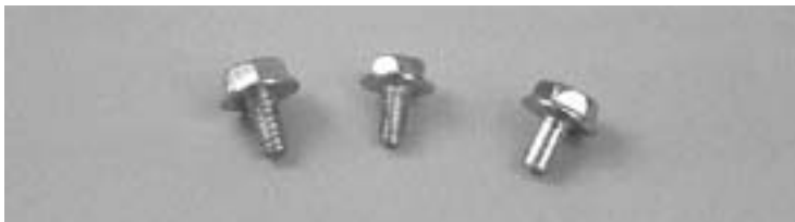
Bild 2.1: Am PC kommen sowohl Grob- (links) als auch Feingewindeschrauben (Mitte) zum Einsatz. Schrauben ohne Gewinde (rechts) bieten die größte Sicherheit, haben sich aber nicht recht durchsetzen können.
