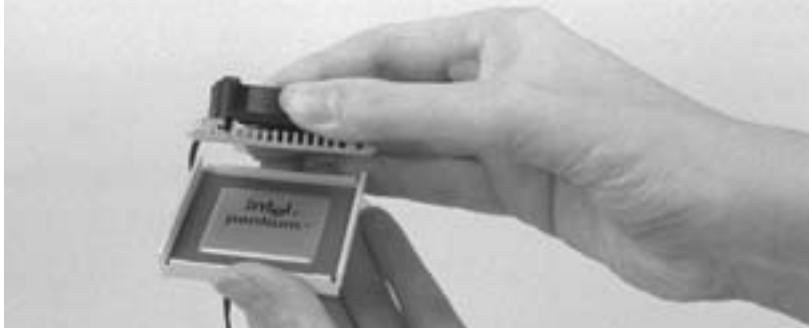
Bild 8.9: Immer schön cool bleiben: Gute Kühlkörper werden mit einer Kunststoffhalterung festgeklemt.
