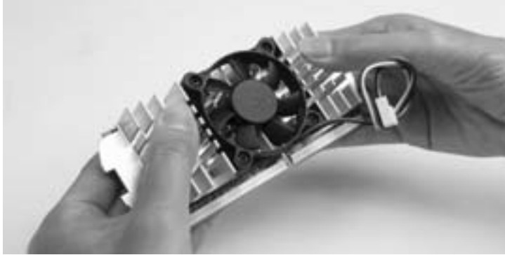
Bild 8.21: Das ist schon ein ziemlich dummes Gefühl: Der Kühler wird dem Celeron gewissermaßen aufgezwungen.
