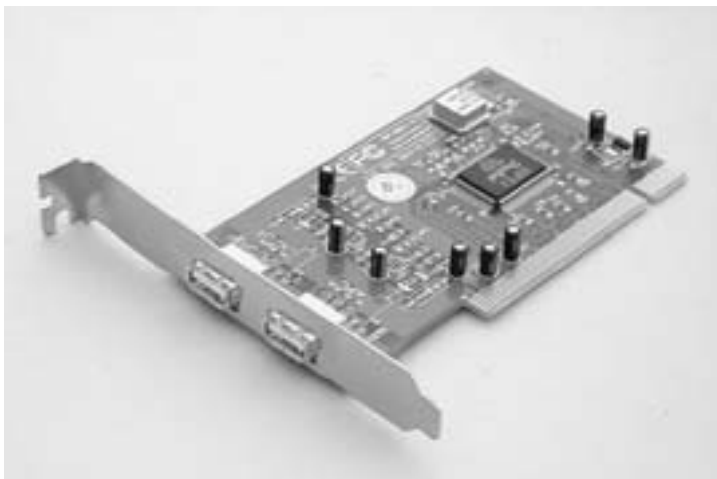
Bild 13.4: Schnittchen à la carte: Mit einer Erweiterungskarte bringen Sie den USB oder FireWire auch auf ältere PCs.
