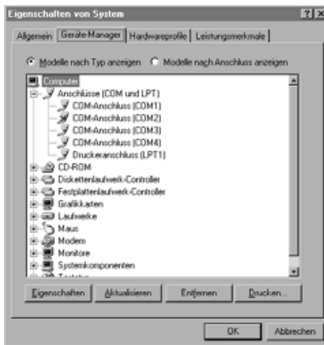
Bild 17.22: Um ein Modem an COM4 einzurichten, müssen vier serielle Anschlüsse eingerichtet werden. COM2 ist deaktiviert, wird nicht benutzt und ist hardwareseitig abgeschaltet.
