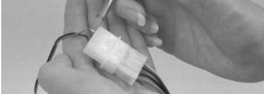
Bild 8.11: Doppelte Gefahr! Wenn beim Anschluss des Ventilators ein Kontakt aus dem Stecker herausgedrückt wird, wird nicht nur die CPU zu heiß, es kann durch das herabhängende Kabel obendrein zu schweren Kurzschlüssen kommen.
