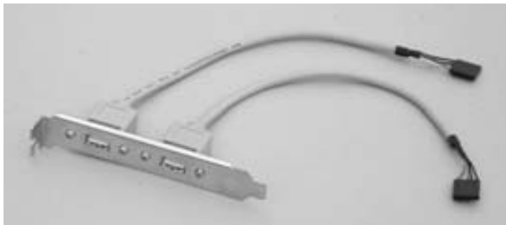
Bild 13.3: Leider nicht ausreichend genormt: Bei BAT-Hauptplatinen benötigen Sie ein spezielles Kabel mit Slotblech, um einen eventuell vorhandenen USB-Anschluss auch zu nutzen.
