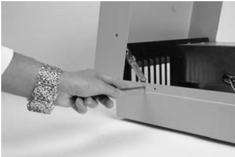
Bild 4.7: Manchmal muss der Deckel ganz ab. Zuerst wird das Aufstellband vom Chassis gelöst ...
